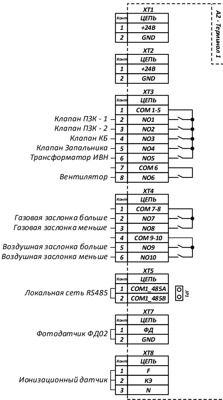
Рис. 3: А2 — Клеммы терминального блока 1.
