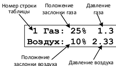
**Редактировать** Здесь вы можете вручную изменить таблицу газ-воздух, вводя значения давлений при помощи кнопок на лицевой панели.
